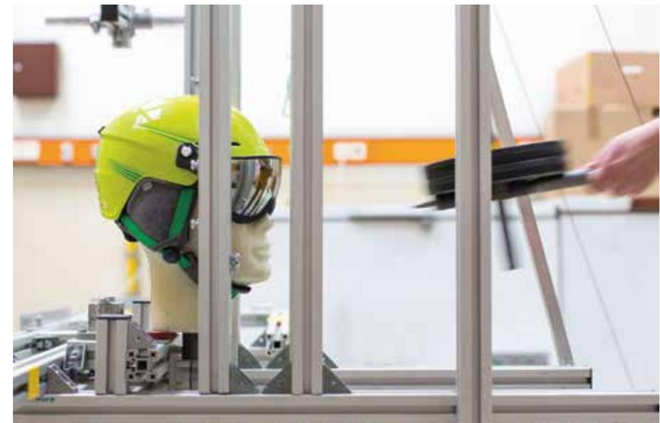
Mit dem Schlagpendel wird überprüft, ob die Brillenscheibe bei einem Aufprall splittert.
